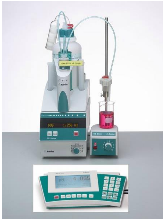
Slika 10. Prikaz aparature koja se koristila tijekom direktne potenciometrije
