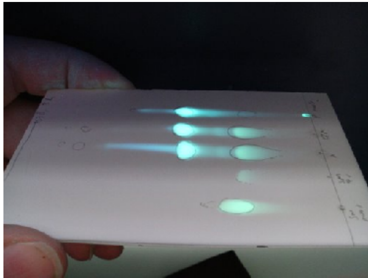
Slika 23. Detekcija komponenti pomoću UV svjetla
