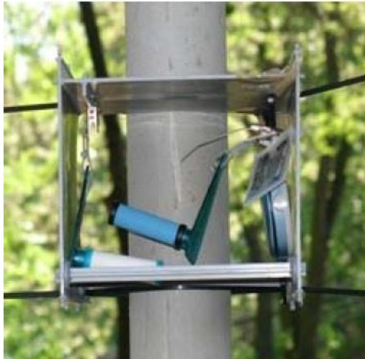
Slika 3.4. Prijedlog postavljanja vanjskog uzorkivača
