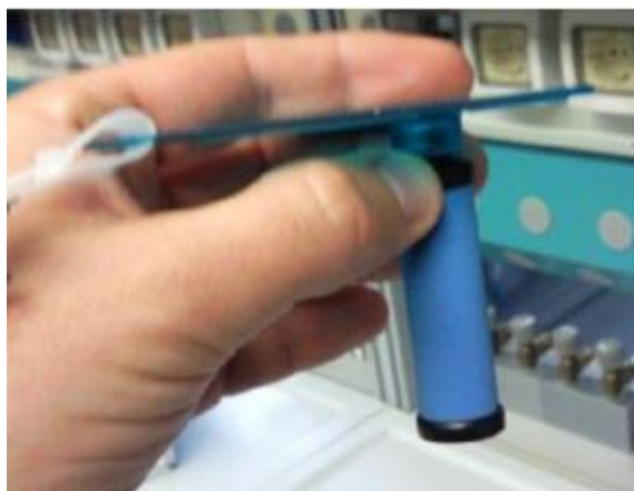
Slika 3.6. Postavljanje difuznog tijela na trokutasti držač
