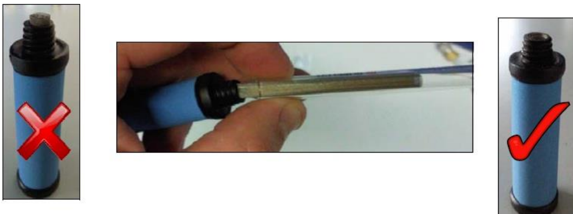
Slika 3.5. Pravilno postavljanje kapsule s adsorbensom u difuzno tijelo
