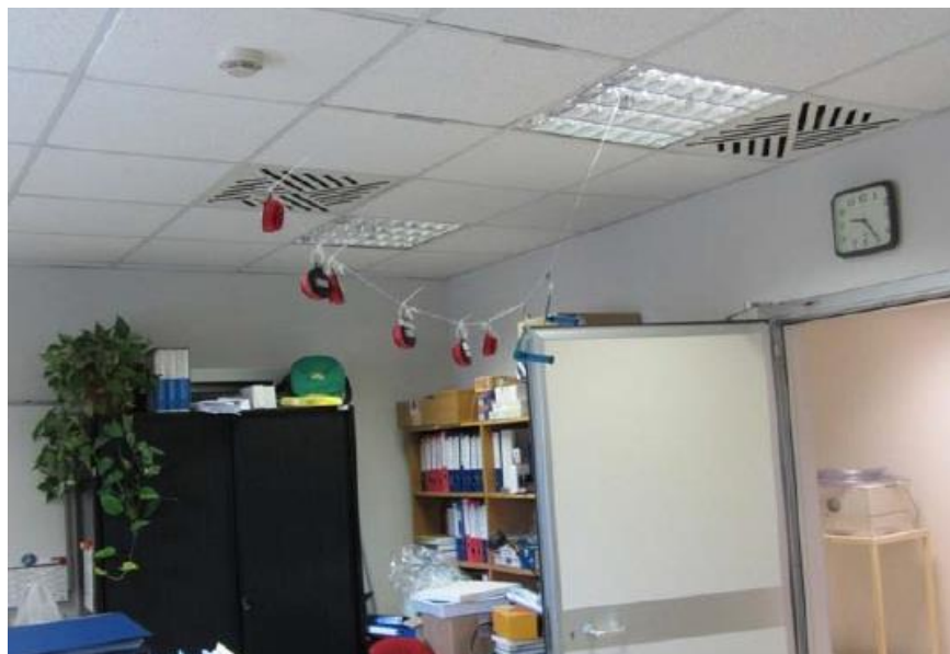
Slika 3.3. Primjer postavljanja uzorkivača u prostoriju
