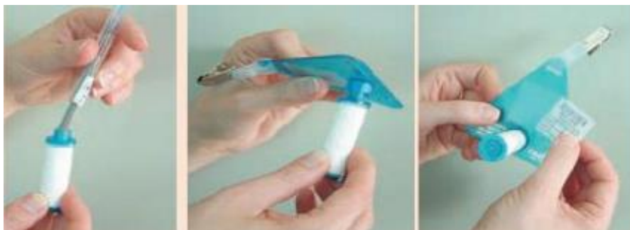
Slika 3.2.1.4. Postupak sastavljanja uzorkivača [24]
