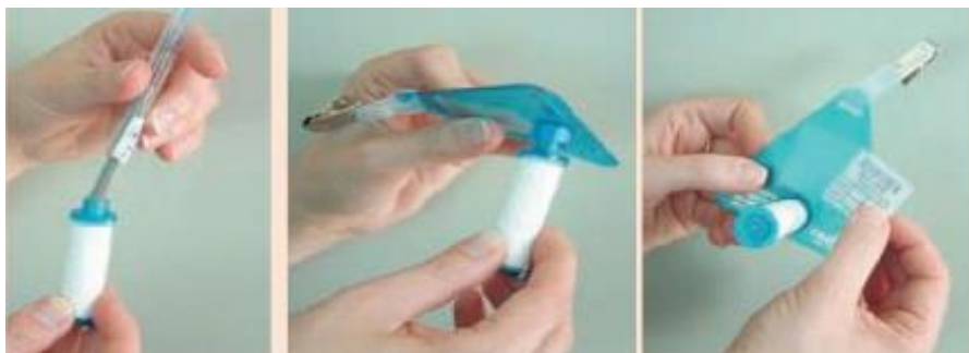
Slika 3.2.1.4. Postupak sastavljanja uzorkivača [24]
