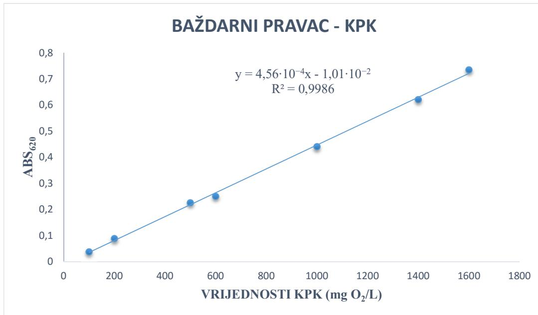
Slika 2.5.. Baždarni pravac za određivanje KPK vrijednosti
