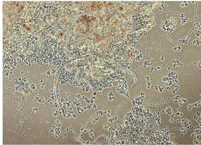
Slika 1.6. Mikroskopska slika aerobnog aktivnog mulja (P=400x) [9]
