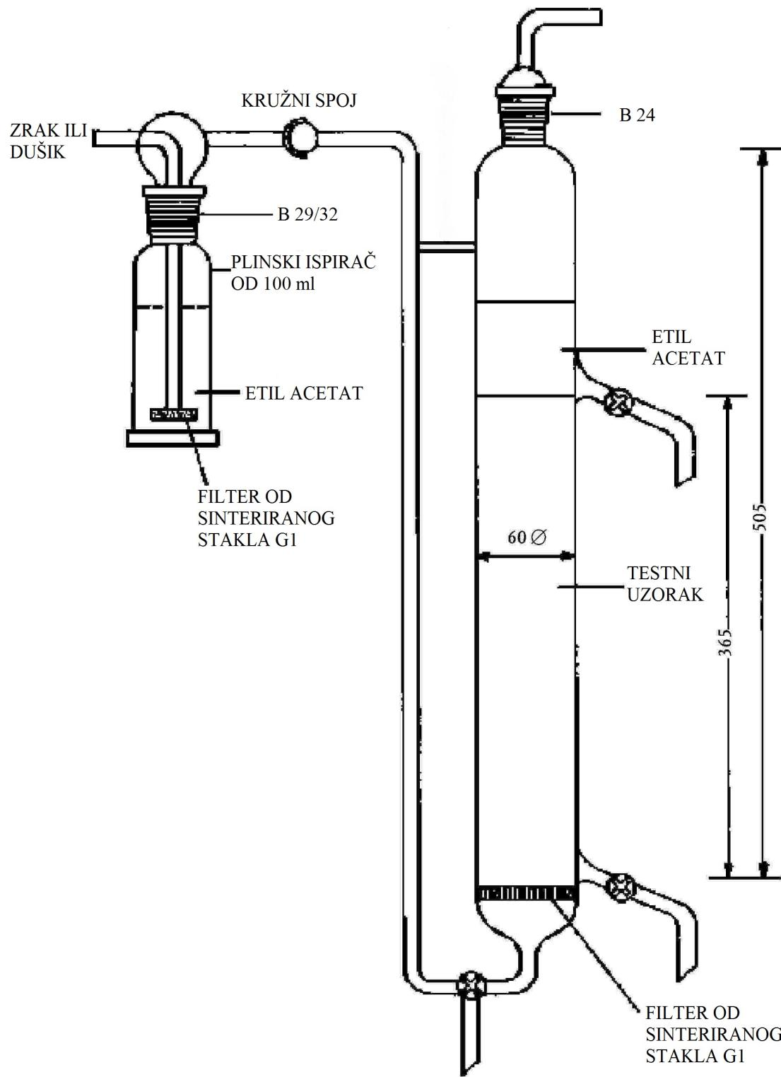
Slika 2.2 Aparatura za plinsko odvajanje [37]
