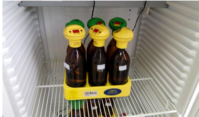
Slika 1.21. OxiTop senzori na bocama s uzorcima za određivanje BPK<sub>5</sub> vrijednosti na magnetskom postolju unutar termostatiranog ormarića
