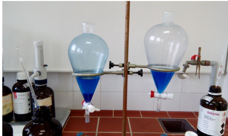
Slika 2.7. Set lijevaka za provedbu MBAS metode
