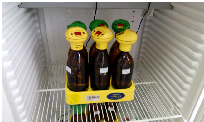
Slika 1.21. OxiTop senzori na bocama s uzorcima za određivanje BPK_5 vrijednosti na magnetskom postolju unutar termostatiranog ormarića
