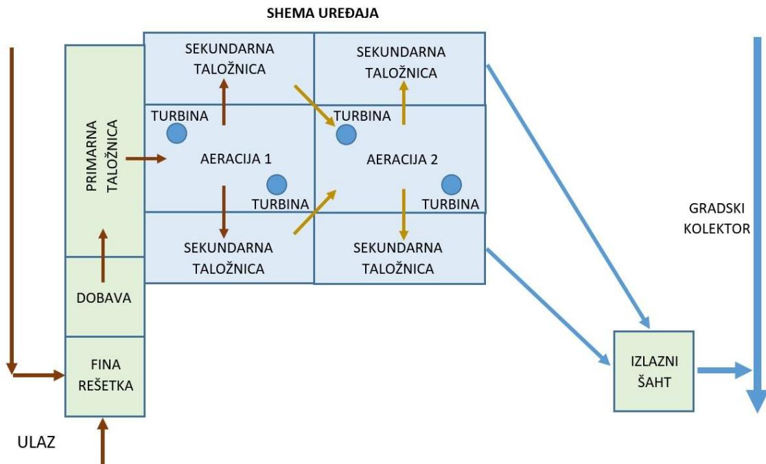
Slika 1.19. Shema aerobnog bioreaktora
