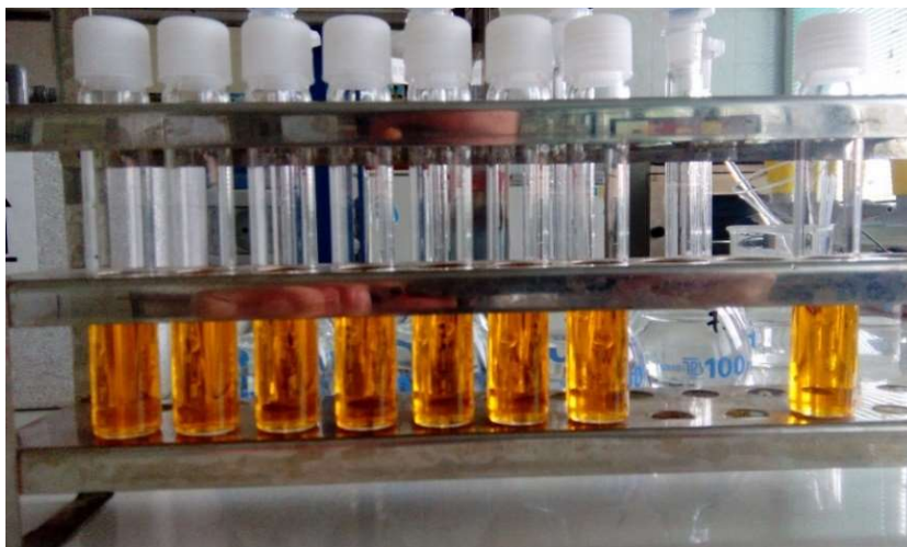
Slika 2.3. Pripremljeni uzorci za izradu baždarne krivulje spremni za refluks
