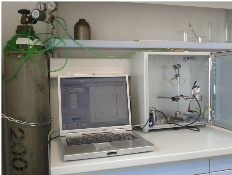
Slika 4. Prikaz aparature korištene za diferencijalnu pulsnu voltametriju.
