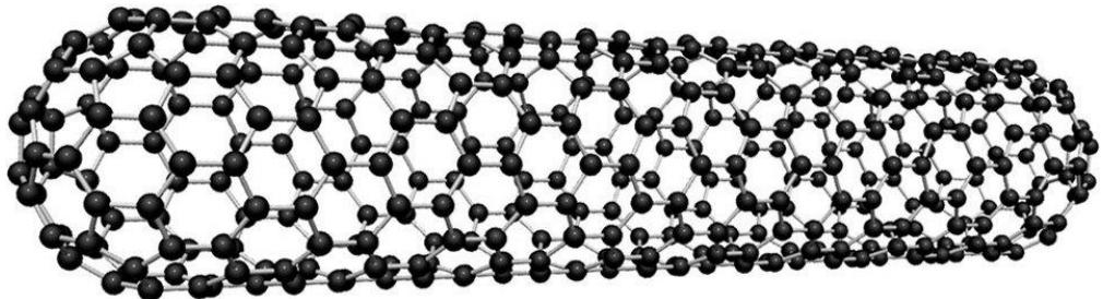
Slika 6. Prikaz jednodimenzinalne nanočestice (nanocjevčica) [18]
