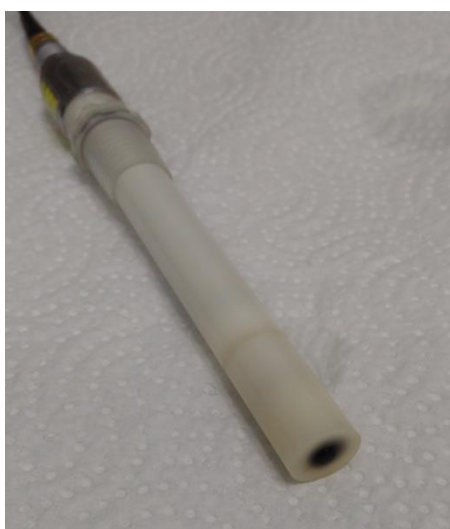
Slika 10. Ionsko selektivna elektroda (MWCNT-TODA-TPB)
