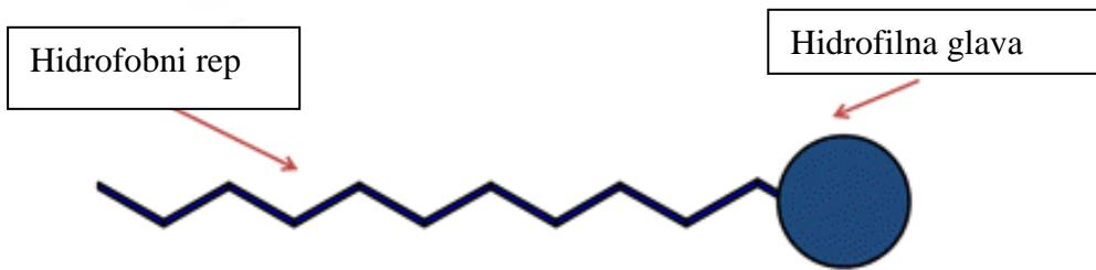
Slika 1. Shematski prikaz molekule tenzida [2]
