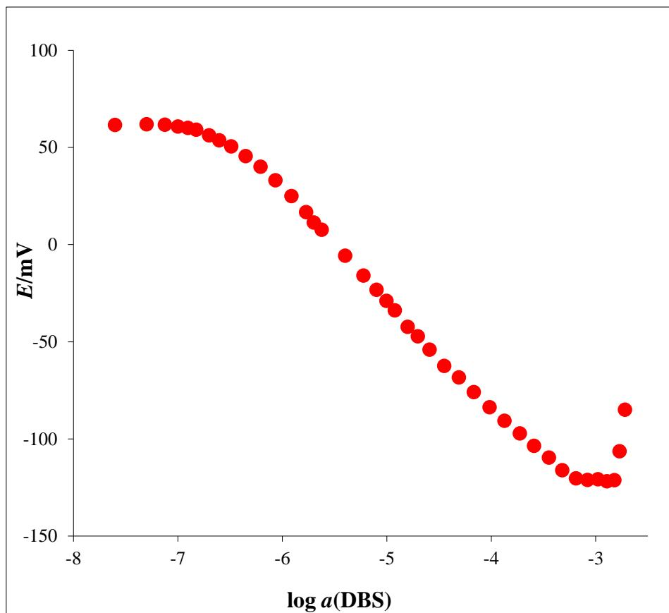
Slika 14. Odzivne karakteristike MWCNT-TODA-TPB elektrode za NaDBS u  $\text{Na}_2\text{SO}_4$
