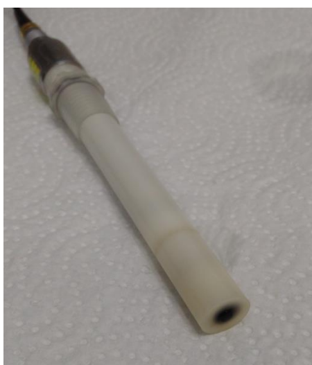
Slika 10. Ionsko selektivna elektroda (MWCNT-TODA-TPB)
