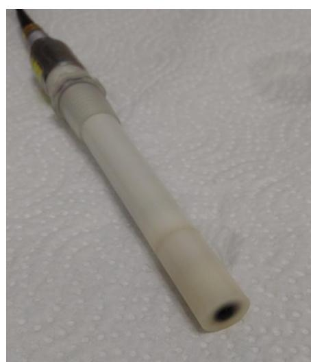
Slika 10. Ionsko selektivna elektroda (MWCNT-TODA-TPB)
