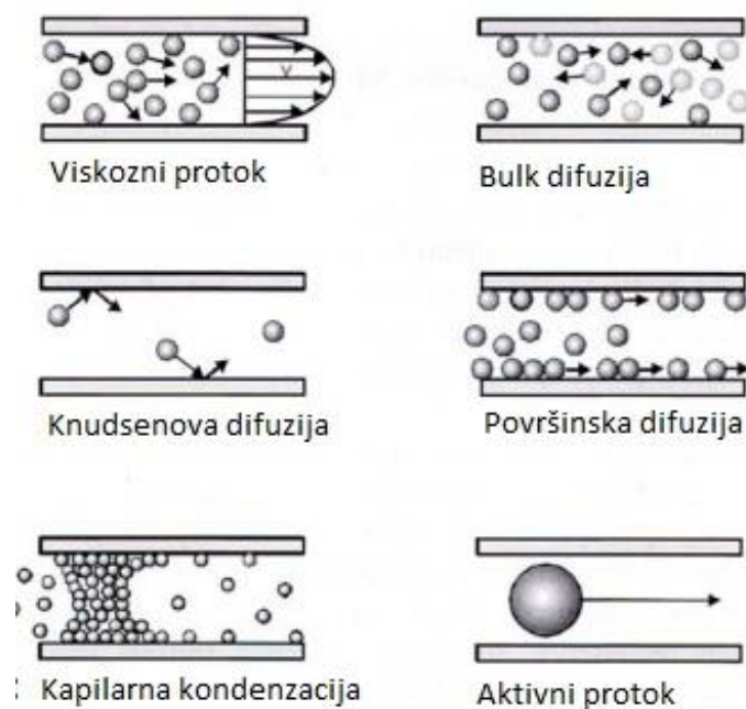
Slika 4. Transportni mehanizam kroz pore
