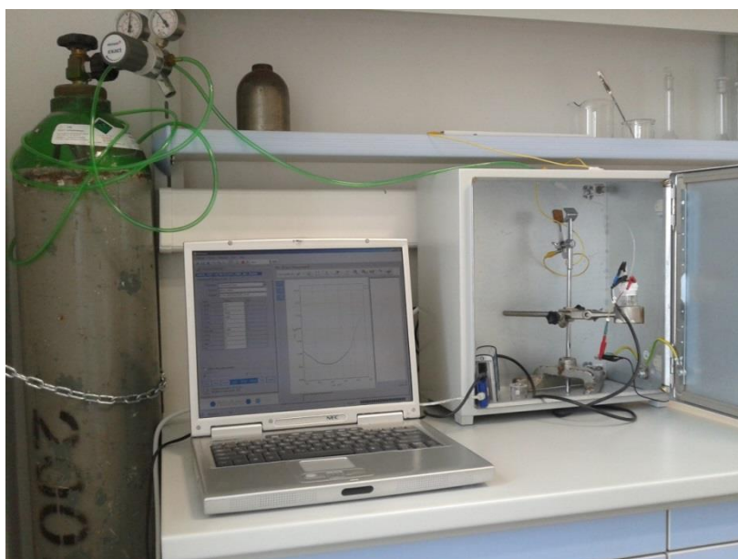
Slika 7. Prikaz aparature za diferencijalnu pulsnu voltametriju.
