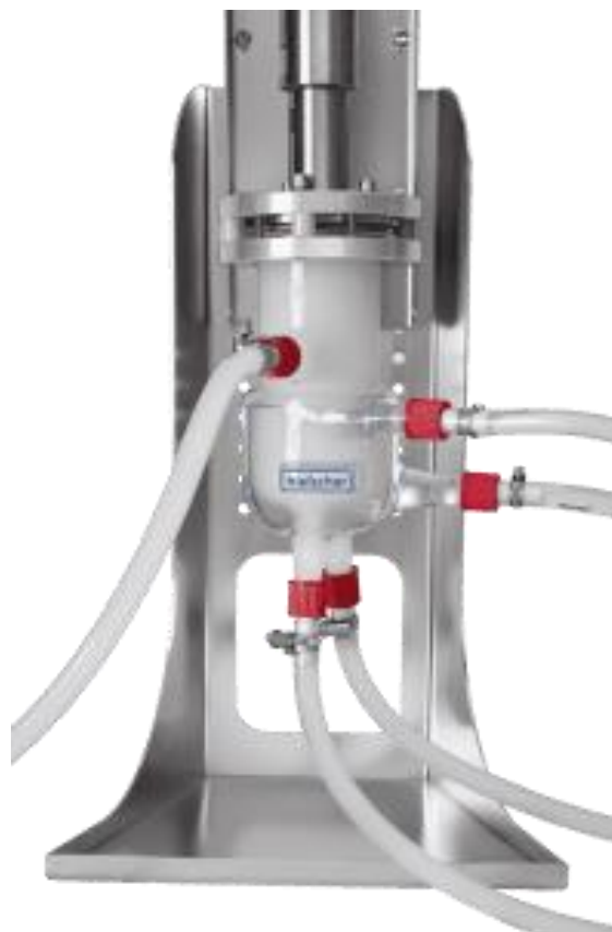
Slika 11. – ultrazvučni reaktor stanica protoka 10
