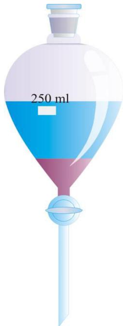
Slika 5. Lijevak za ekstrakciju<sup>[15]</sup>.
