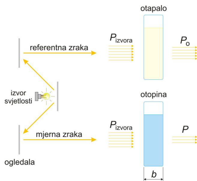
Slika 8. Shematski prikaz spektrofotometra s dva snopa svjetlosti<sup>[20]</sup>.
