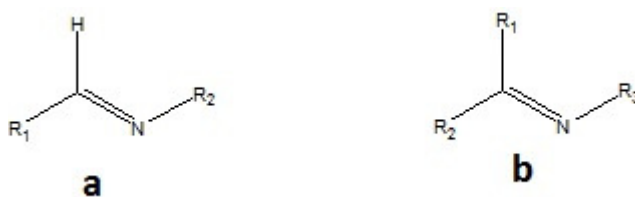
Slika 1. a - Opća formula Schiffove baze nastale iz aldehida, b - opća formula Schiffove baze nastale iz ketona 1
