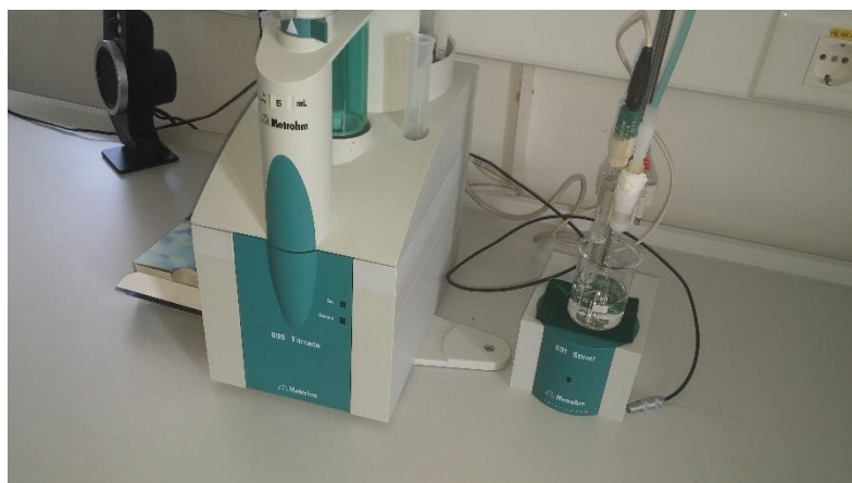
Slika 3.1. Aparatura za potenciometrijska mjerenja (Metrohm, Švicarska).
