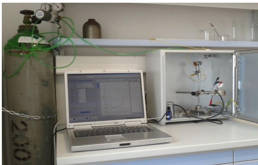
Slika 8. Prikaz aparature za voltametrijska mjerenja (PalmSens potencijostat/galvanostat)
