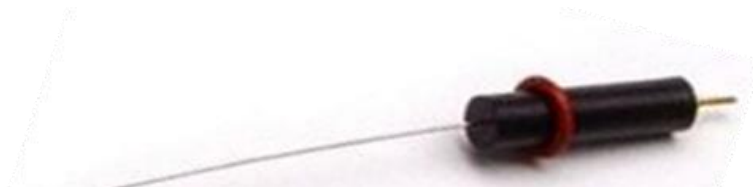
Slika 13. Protuelektroda platinska žica [21].
