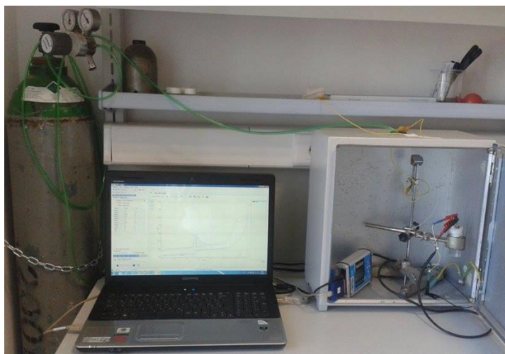
Slika 11. Aparatura za voltometrijska mjerenja (PalmSens potencijostat/galvanostat).
