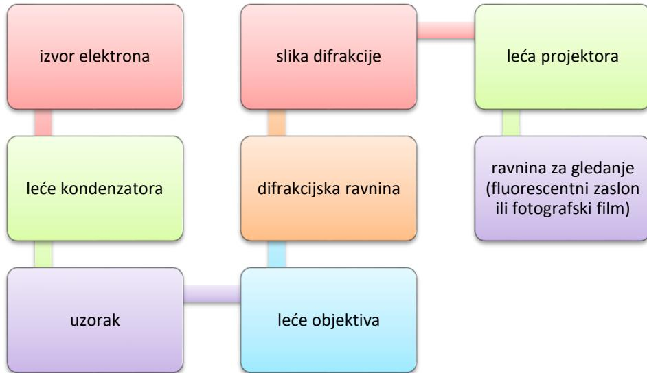
Slika 19. Osnovne komponente transmisijskog elektronskog mikroskopa.
