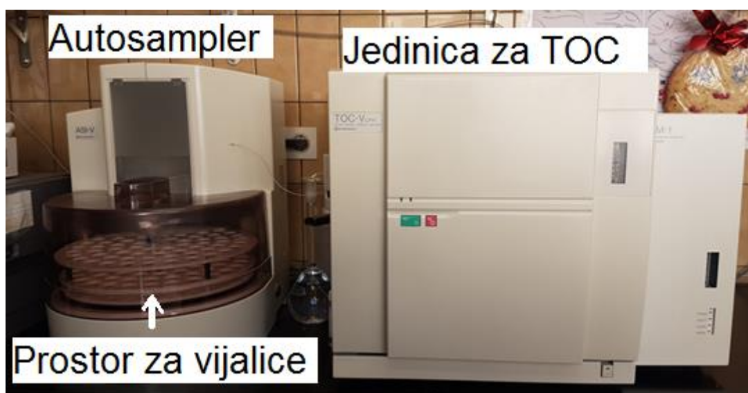
Slika 15. TOC analizator, Shimadzu, 2010.
