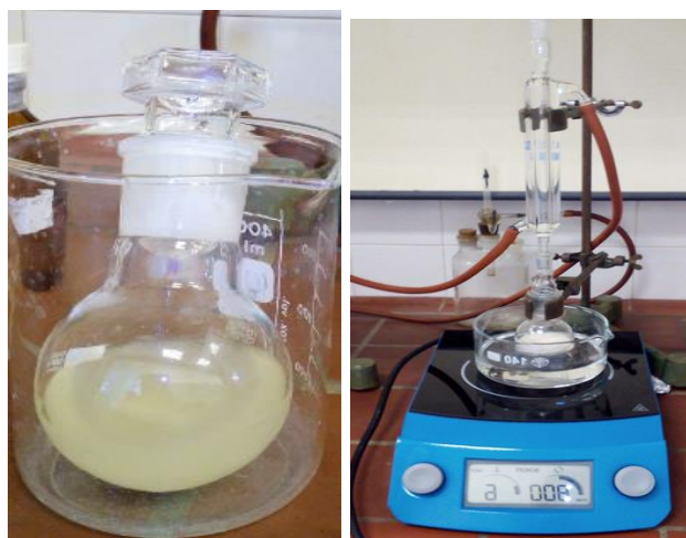
Slika 11. Priprava eutektičkog otapala kolin-klorid/urea
