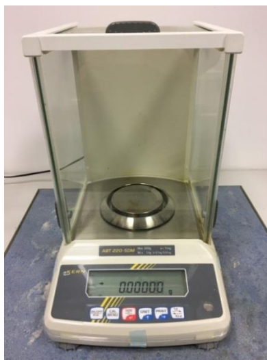
Slika 16: Prikaz vage korištene za pripremu uzoraka.
