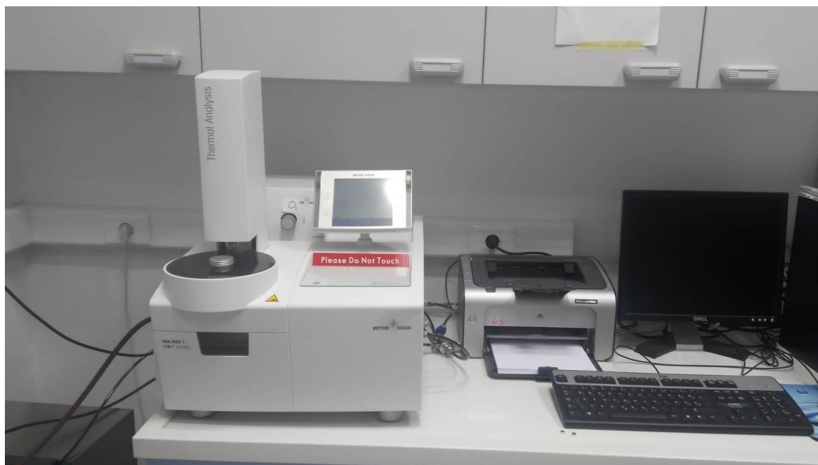
Slika 14. TGA/DSC 3+ uređaj s Odjela za kemiju (Mettler Toledo)
