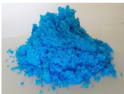
Slika 8. Kristali i struktura bakrovog(II) sulfata pentahidrata (8)
