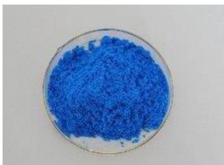
Slika 9. Kristali vandil(IV)sulfata monohidrata i njegova strukturna formula (9)
