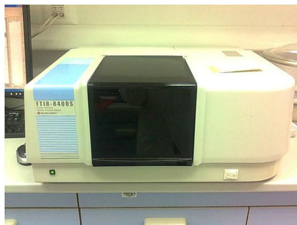
Slika 18. Infracrveni spektrofotometar s Fourierovom transformacijom signala, FTIR-8400s
