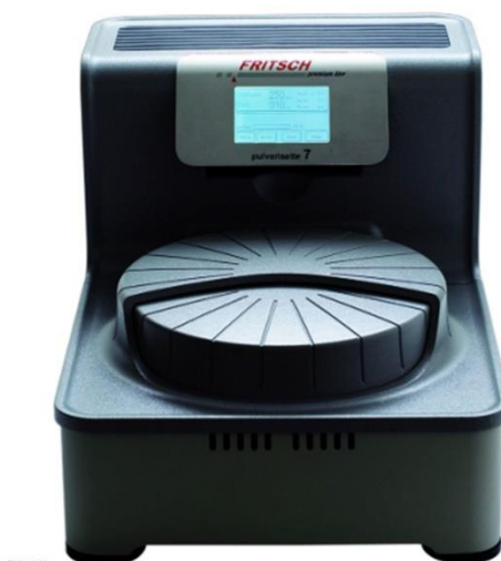
Slika 8. Planetarni mlin korišten kod sinteze kalcijeva oksalata.
