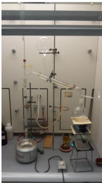
Slika 3. Aparatura za destilaciju suhog diklormetana
