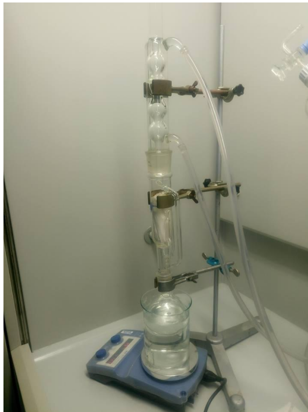
Slika 9. Soxhlet aparatura korištena prilikom određivanja sadržaja slobodnih masti.
