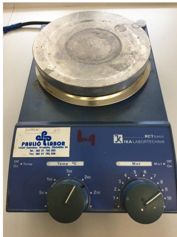
Slika8. Magnetska miješalica s grijanjem ( IKA, Njemačka)
