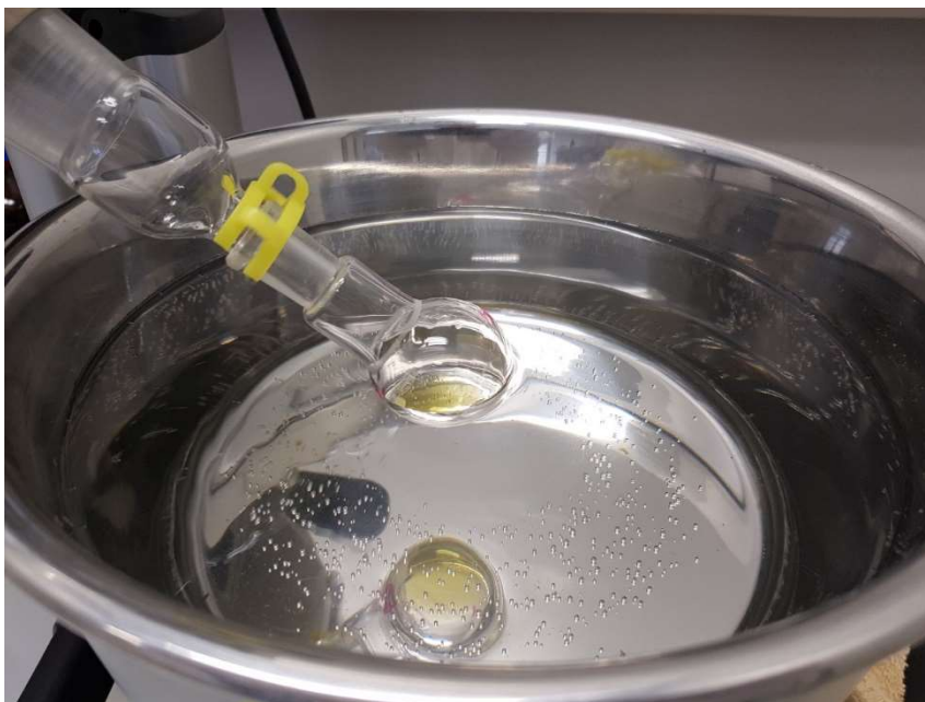
Slika 11. Uparivanje otapala iz otopine do uljnog ostatka.
