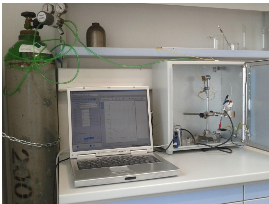
Slika 3.2.3. Aparatura za cikličku voltametriju
