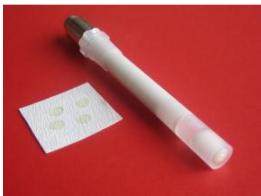
Slika 10: Tenzidno-osjetljiva elektroda s PVC membranom vlastite izradbe [7.]
