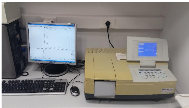
Slika 3.7. Aparatura za UV/VIS mjerenja, Shimadzu 1700 [6].
