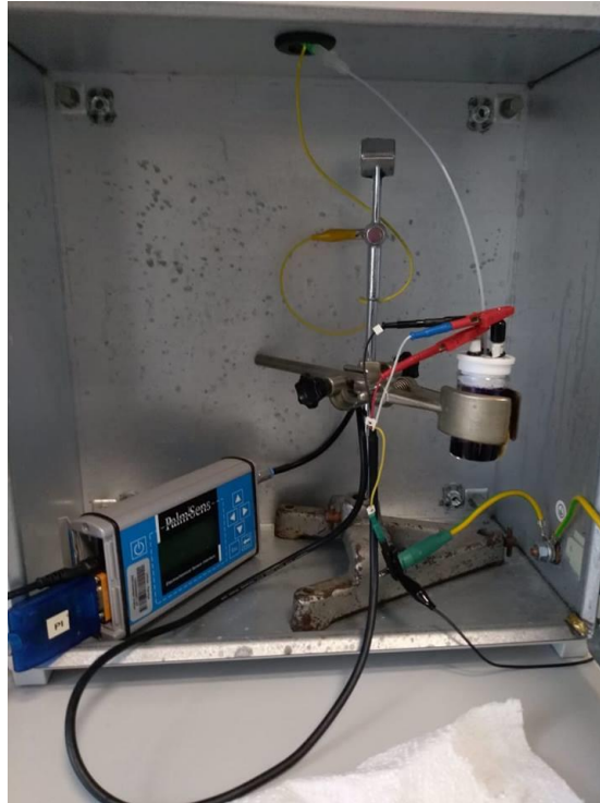
Slika 15. Elektrokemijska ćelija s troelektrodnim sustavom.
