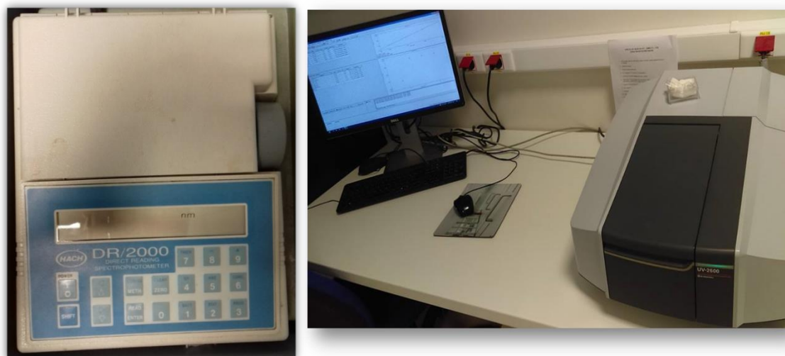
Slika 15. Uređaji za spektrofotometrijska mjerenja: a) DR/2000 spektrofotometar, Hach i b) UV-2006 spektrofotometar, Mettler Toledo.
