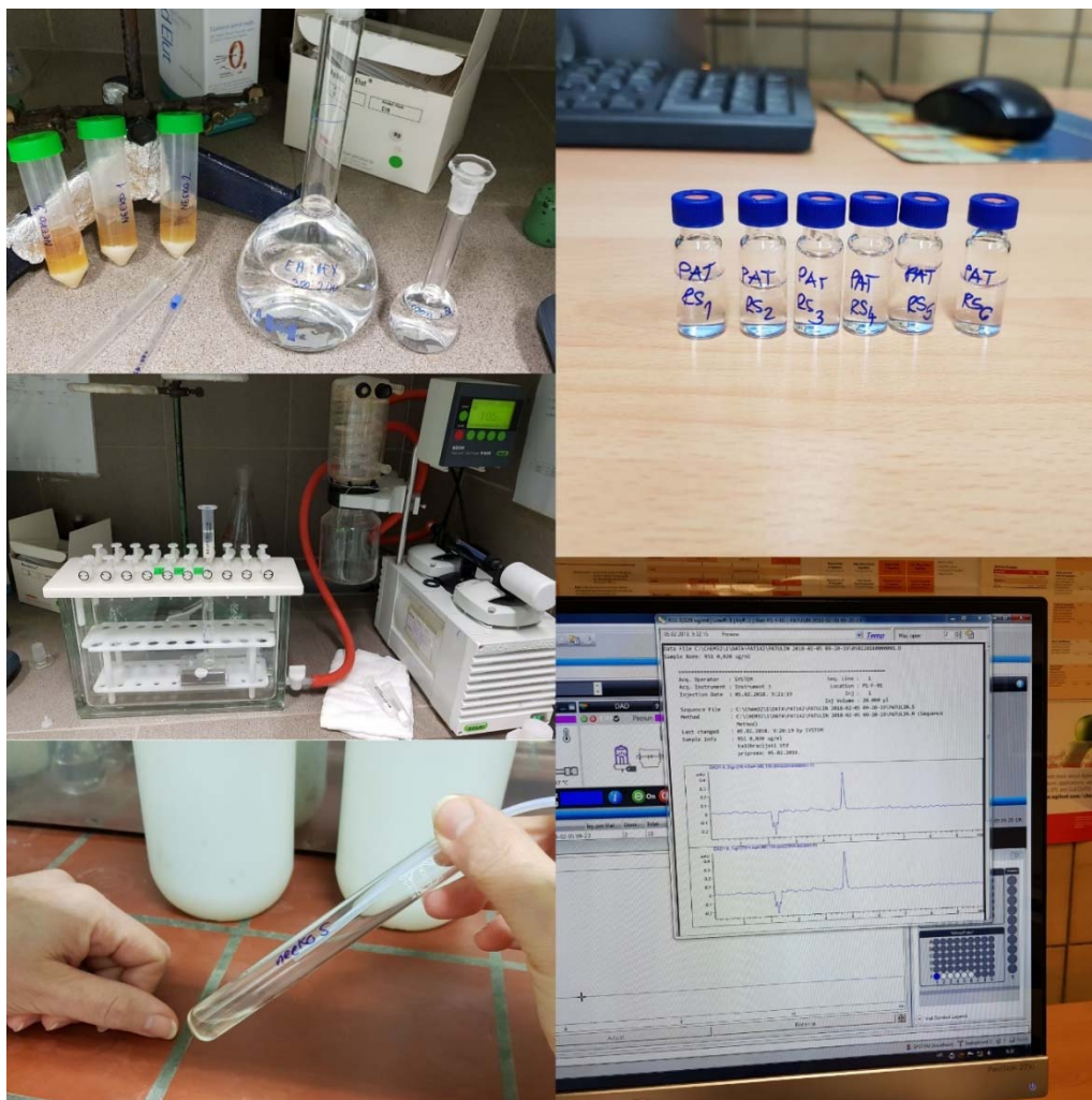
Slika 13. Tijek analize određivanja patulina u prehrambenim proizvodima.
