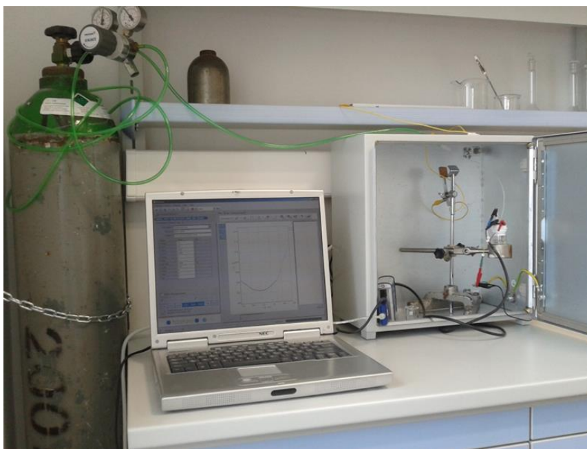
Slika 11. Aparatura za cikličku voltametriju (PalmSens potencioštat/galvanostat).
