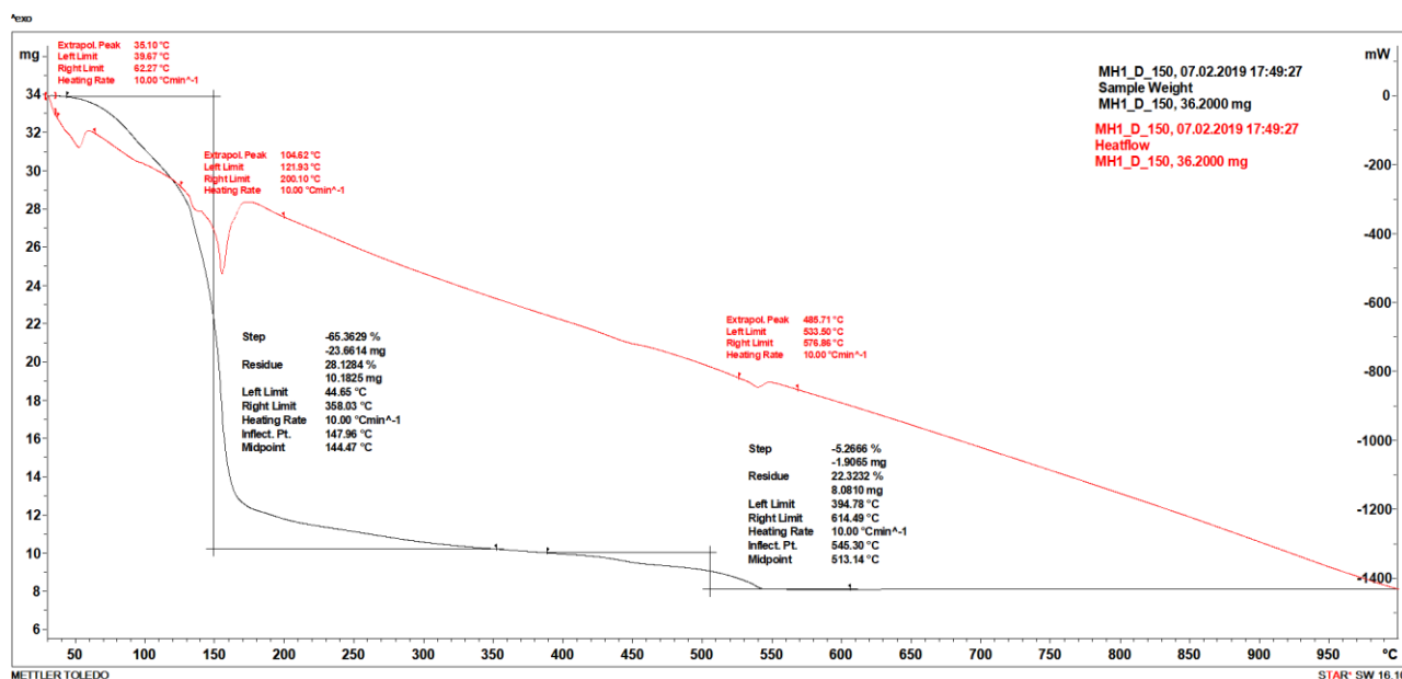
Slika 19. Rezultati TGA analize spoja MH1 D 150.
