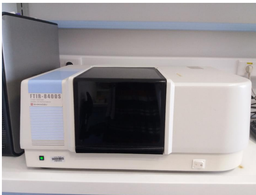
Slika 10. Shimadzu FT-IR 8400S spektrometar.
