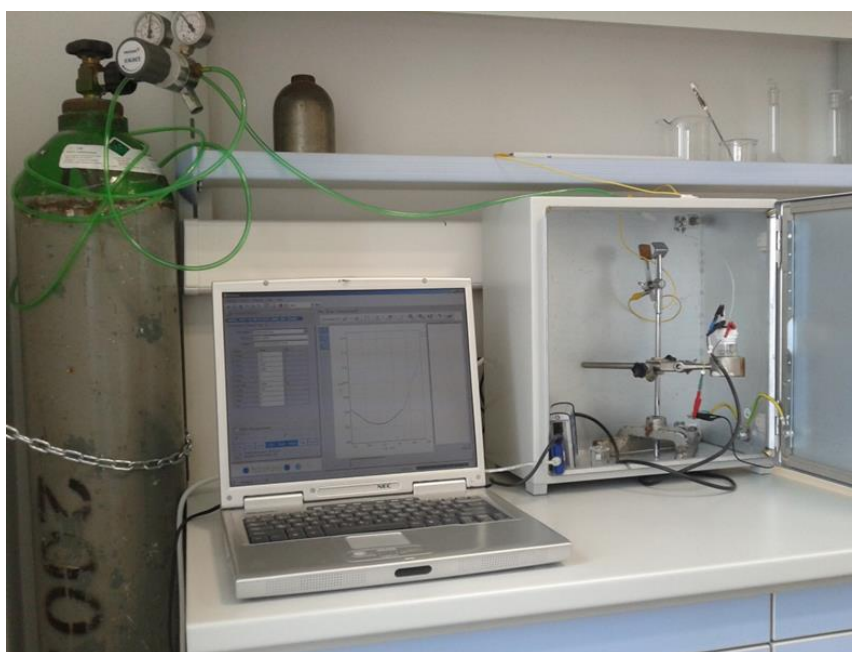
Slika 11. Aparatura za cikličku voltametriju ( PalmSens potencioštat/galvanostat ).
