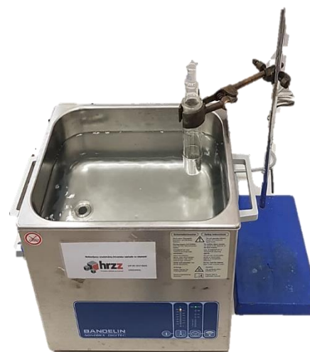
Slika 3.2. Aparatura za ultrazvučnu sintezu
