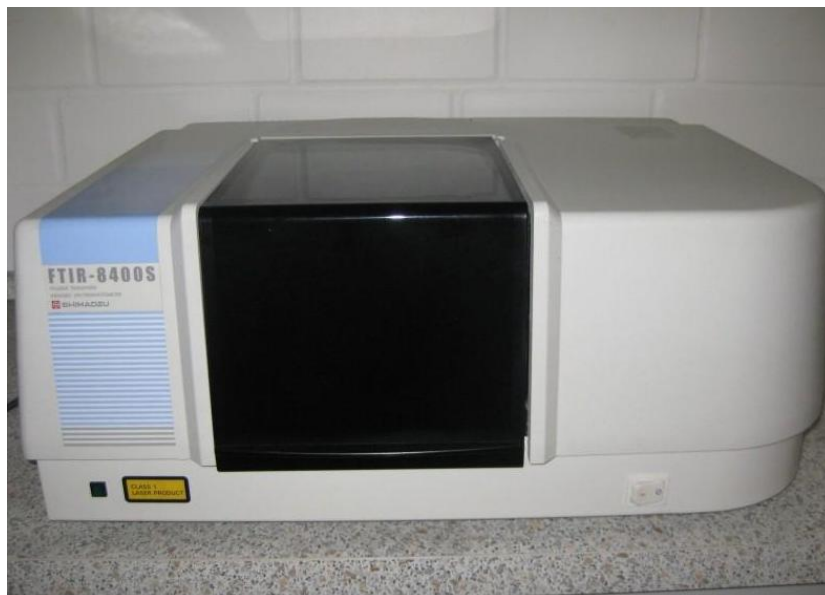
Slika 10. FT-IR spektrometar (Shimadzu FT-IR 8400S) [24]
