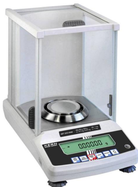
Slika 8. Digitalna analitička vaga (Kern ALS 220-4NM) [22]
