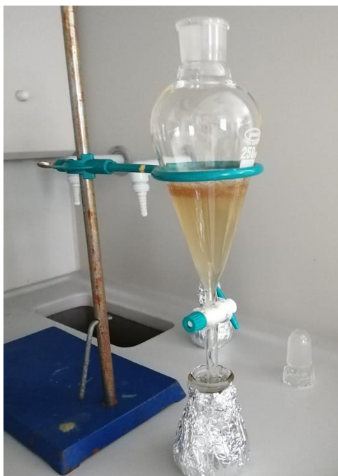
Slika 8. Prikaz ekstrakcije DAN-a s cikloheksanom u lijevku za odjeljivanje
