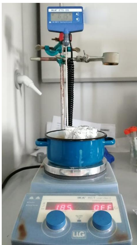
Slika 13. Prikaz grijanja otopina pri čemu dolazi do stvaranja kompleksa Se-DAN
