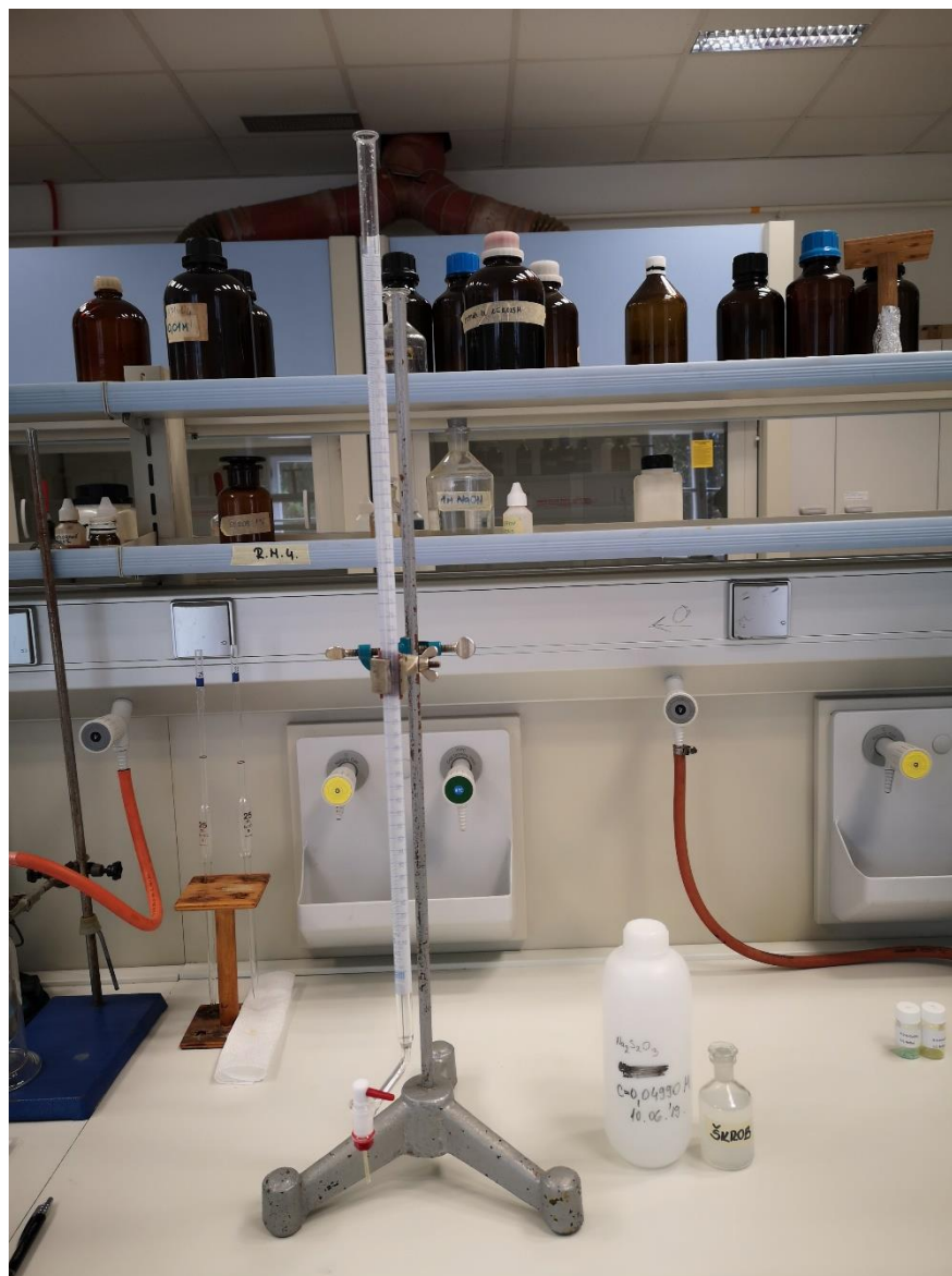
Slika 10. Slika aparature za jodometrijsko određivanje udjela bakra(II) u spojevima
