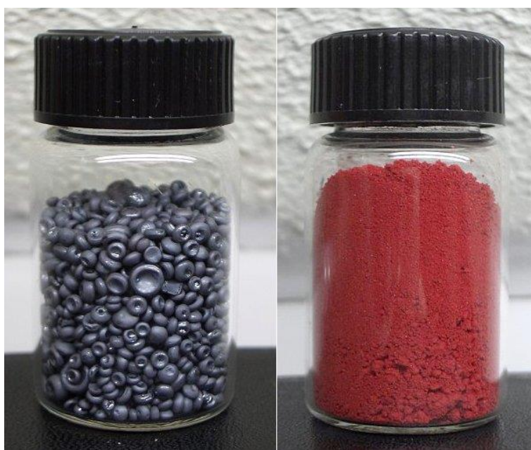
Slika 2. Alotropske modifikacije selenija.
