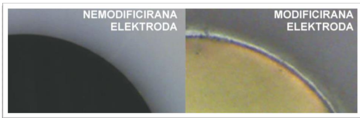
Slika 20. Prikaz površine nemodificirane i modificirane elektrode od staklastog ugljika snimljene na svjetlosnom mikroskopu ELV 79852 (maksimalno uvećanje 500 puta) [26].
