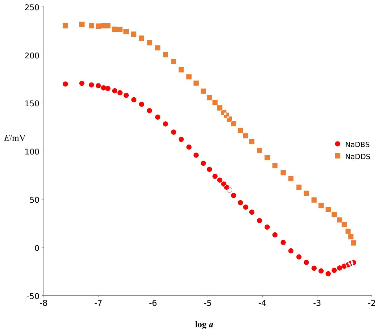
Slika 10. Usporedba odziva MWCNT – TPB elektrode na NaDDS i NaDBS u vodi
