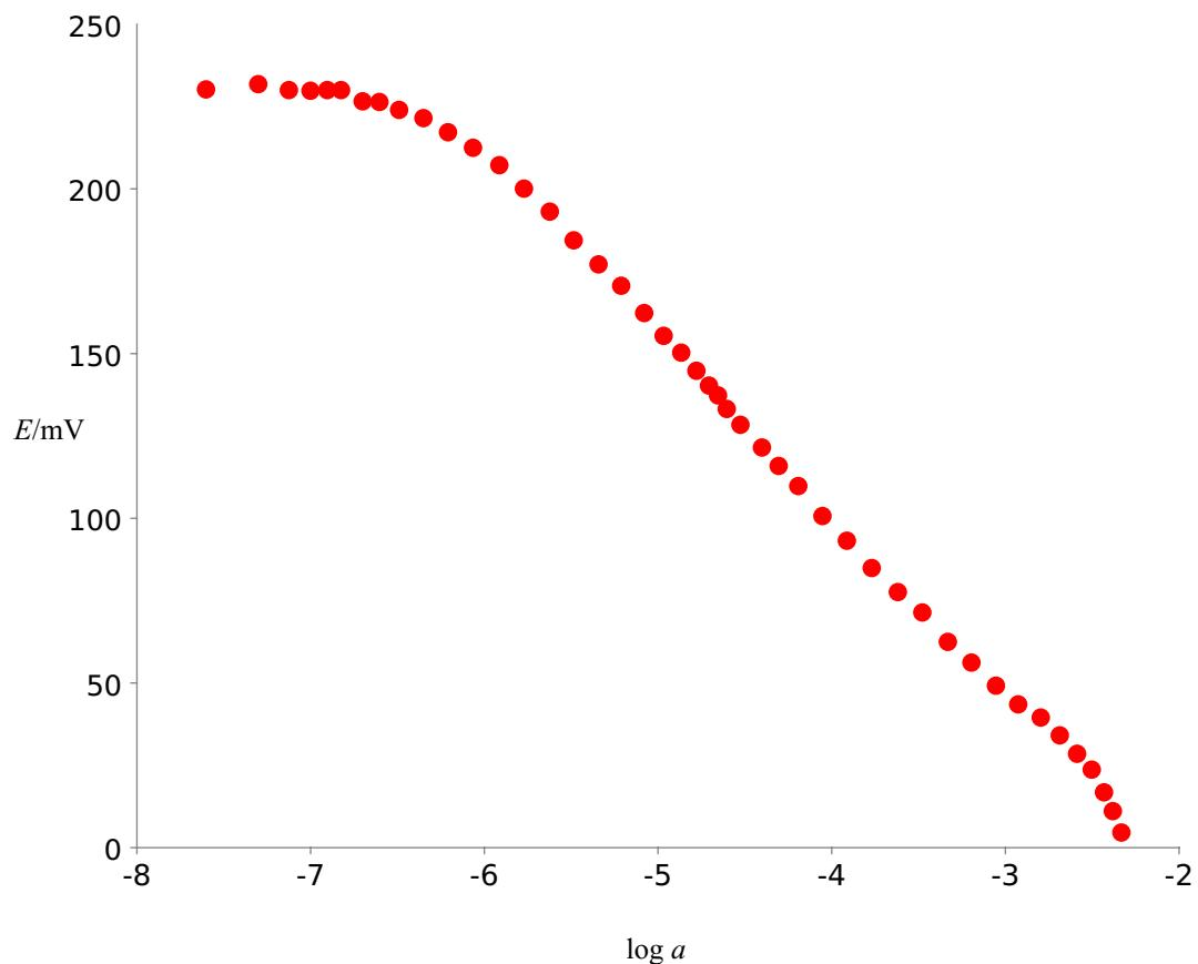
Slika 8. Krivulja odziva MWCNT – TPB elektrode na NaDDS u vodi
