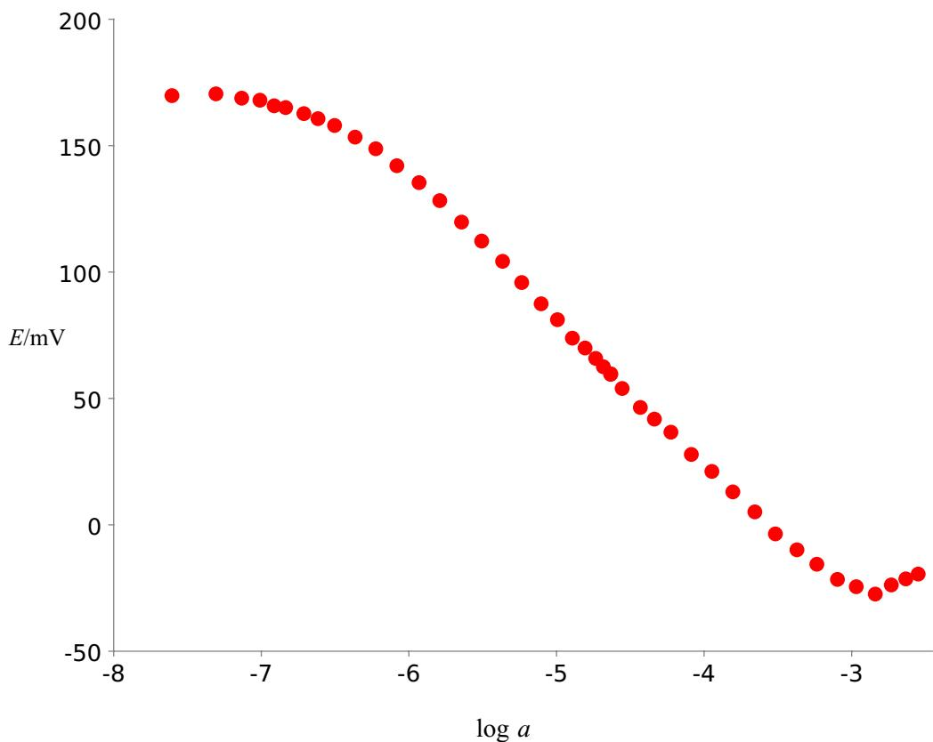
Slika 9. Krivulja odziva MWCNT – TPB elektrode na NaDBS u vodi
