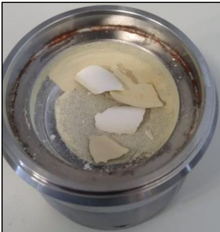
Slika 21. Uzorak MH2 nakon 2 sata mljevenja u reaktoru planetarnog kugličnog mlina Fritsch Pulverisette Premium 7 line; Gornji sloj uzorka je poprimio blijedo žutu boju u odnosu na donji sloj koji je ostao bijele boje.
