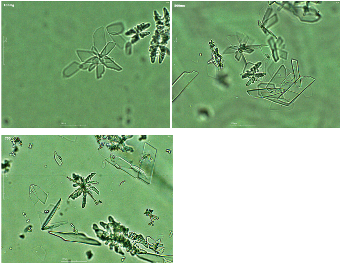
Slika 29. Morfologija kristala kalcijeva oksalata u NaCl sustavu s 100 mg, 750 mg i 1000 mg vitamina C.
