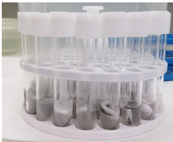
Slika 17. Uzorci u otopini koncentrirane dušične kiseline.
