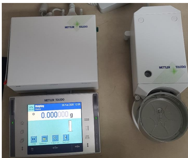
Slika 14. Mettler Toledo vaga sa osjetljivošću od 10^{-6} g.
