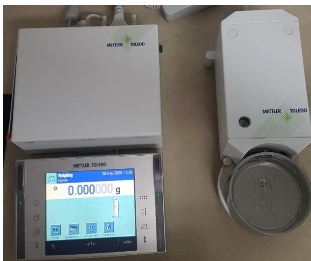
Slika 14. Mettler Toledo vaga sa osjetljivošću od 10^{-6} g.
