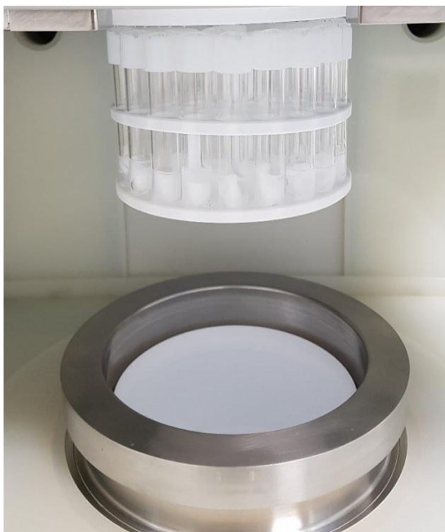
Slika 18. Uzorci prevedeni u otopinu (kvarcni filteri bijele boje).
