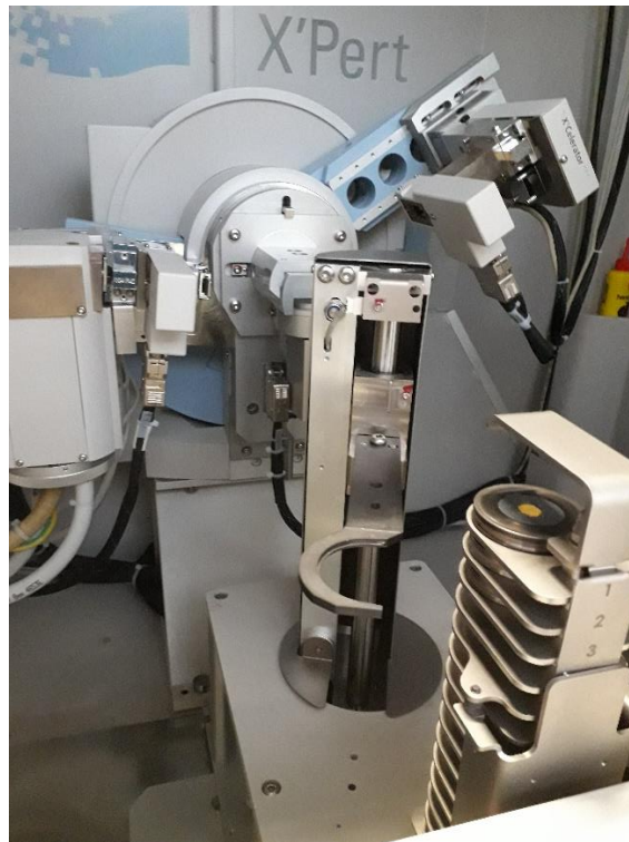
Slika 31. Panalytical X'Pert Pro difraktometar.
