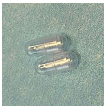
Slika 17. Kapsule za praškaste uzorke potrebne za snimanje na magnetometru [30].
