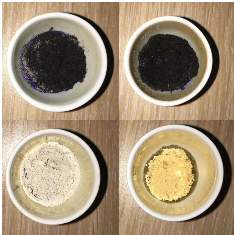
Slika 22. Uzorci 1 (gore lijevo), 2 (gore desno), 3 (dolje lijevo) i 4 (dolje desno) nakon drugog koraka kalcinacije.
