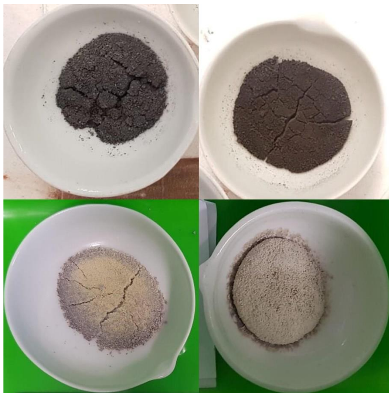
Slika 21. Uzorci 1 (gore lijevo), 2 (gore desno), 3 (dolje lijevo) i 4 (dolje desno) nakon prvog koraka kalcinacije.
