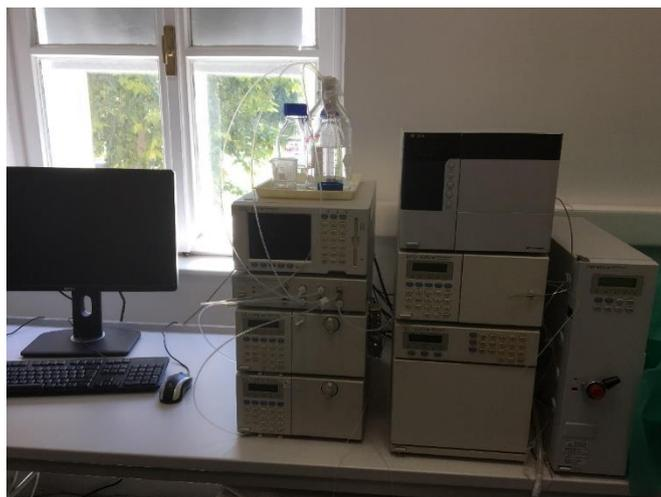
Slika 11. Tekućinski kromatograf visoke razlučivosti (Shimadzu).
