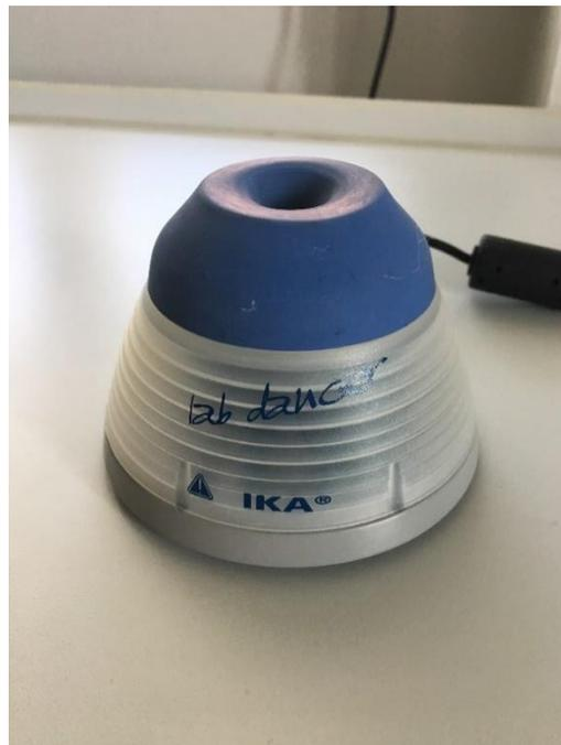
Slika 14. Laboratorijska treskalica za epruvete (IKA, Njemačka).
