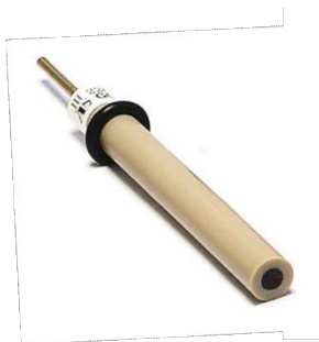
Slika 26. Radna elektroda od staklastog ugljika (GC-elektroda).
