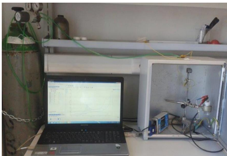
Slika 10. Aparatura za voltametrijska mjerenja.
