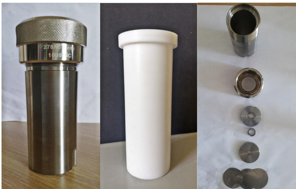
Slika 15. Prikaz korištenog autoklava i njegovi sastavni dijelovi.
