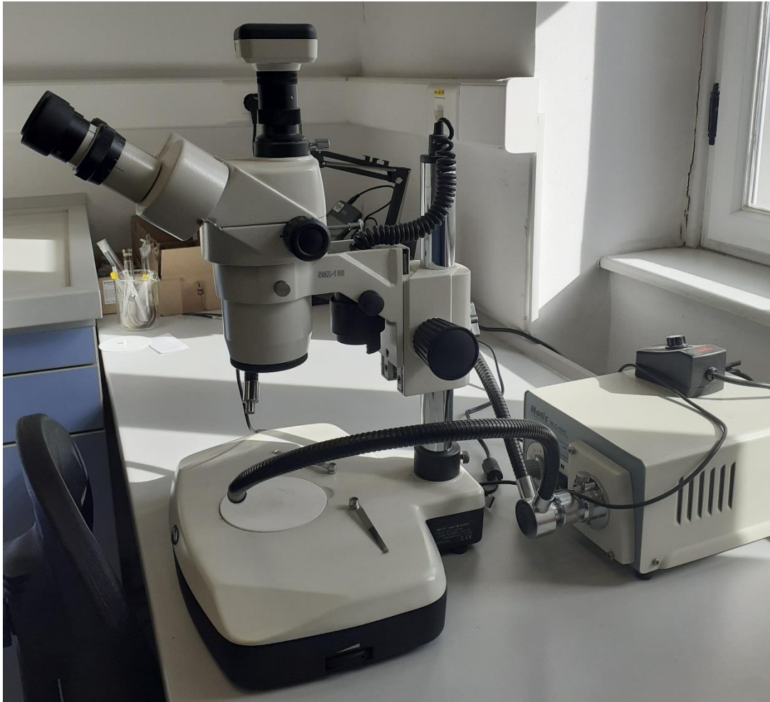
Slika 13. Optički mikroskop korišten za proučavanje nastalih kristala.
